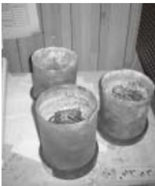
図13 フラスコに固定されたツリー
