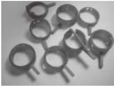
図11 湯道が付けられたワックス原型
