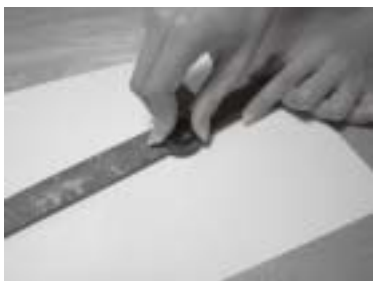
図7 ワックスの側面を整える
