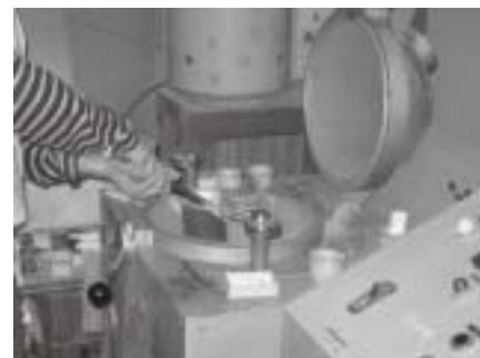
図17 鋳型を鋳造機から取り出す
