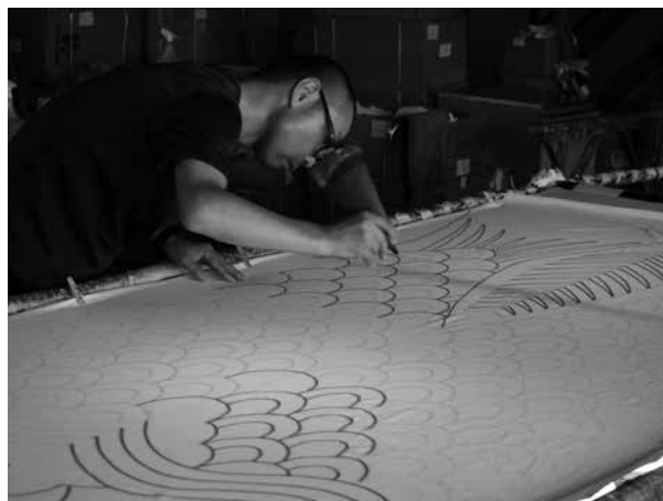
写真1 「筒引き」の工程
