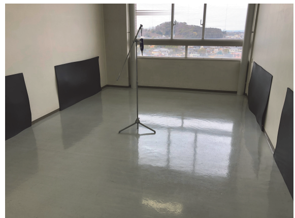
(4) ラバーシート4枚とポリスチレンフォーム断熱材5枚を壁に設置した状態
